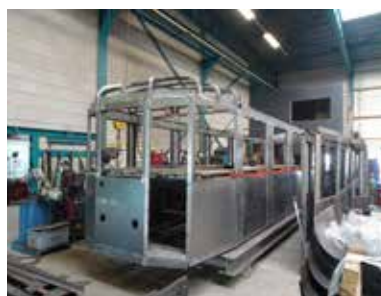
Enkele dakspanten zijn inmiddels aangebracht.
