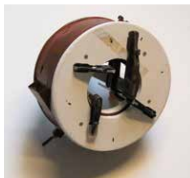
Basisplaat en achterplaat verlijmd en met verzonken schroeven verbonden.
