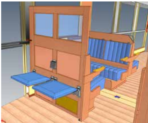
Interieur, scheidingswand met klapbanken. Samenstelling motordraaistel.
